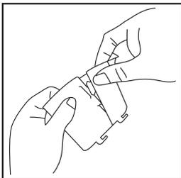
Befestigen Sie die beiden Enden des Projektionsfilms. (Die helle Seite mit der Schutzfolie zeigt nach außen)
