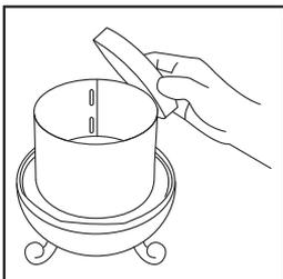
Stellen Sie den runden Projektionsfilm in den Kreis der Führungsschiene und setzen Sie den Deckel auf den Zylinder.
