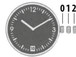
**Acerto da hora:** Puxe a coroa com cuidado para a posição 2 para modelo WW 0601-01 (M) e para a posição 1 para todos os outros modelos. Acerte a hora rodando a coroa no sentido dos ponteiros do relógio (orientando-se pela hora do seu relógio, rádio ou outro aparelho com indicação das horas) e depois prima a coroa de novo para a posição 0.
