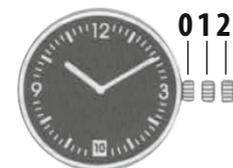
Krone zur 1. Klickstellung herausziehen und durch Drehen entgegen des Uhrzeigersinns das Datum einstellen. Nach dem Einstellen des Datums die Krone in die Normalstellung 0 zurückdrücken. Eine Datumskorrektur müs-
