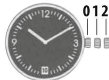
Krone zur 1. Klickstellung herausziehen und durch Drehen entgegen des Uhrzeigersinns das Datum einstellen. Nach dem Einstellen des Datums die Krone in die Normalstellung 0 zurückdrücken. Eine Datumskorrektur müs-
