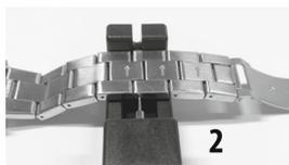
Benutzen Sie zum Kürzen das mitgelieferte Werkzeug (1) und legen Sie eine kleine Zange bereit. Justieren Sie die Uhr so, dass Sie mit der Spitze des Werkzeugs durch Drehen an der Schraube den Stift aus dem Glied drehen können (2).
